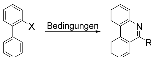
Schema 2-15: Darstellung von Phenanthridinen. R wird der Übersicht wegen nicht weiter definiert, ebenso mögliche Substituenten am Biphenylsystem.
