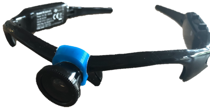
Abbildung 3.2: Kamerabrille des Modells HDC-700 der Marke OctaCam mit daran angebrachtem Fisheye-Objektiv
